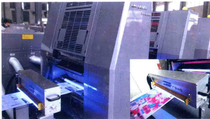
广发光电UV-LED应用于浙江炜冈ZX-320型间歇式PS版印刷机
