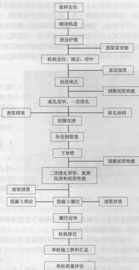
图 1-1 超长灌注桩的工艺流程图
