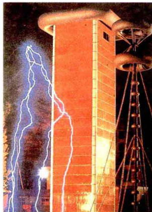
6000千伏冲击电压发生器20米长间隙放电
