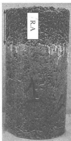
(a) 未掺加超塑化剂的圆柱体试件
