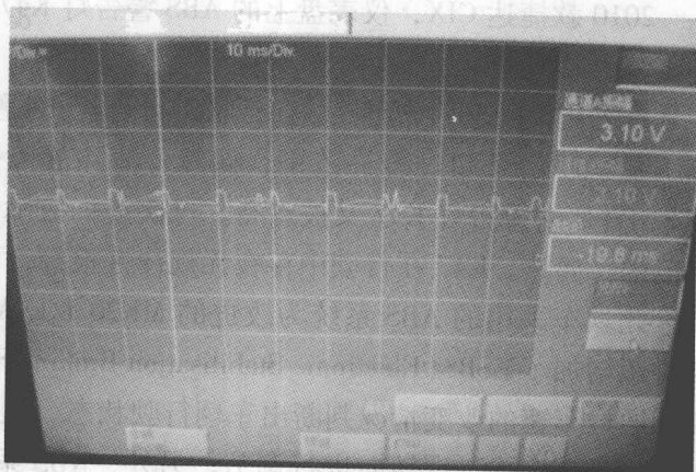
图 1-7 故障车动力总线波形
