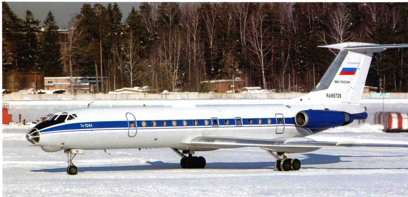
下图：Tu-134AK RA-65729/“蓝色10”[以前的Tu-134“巴尔卡尼（Balkany）”]指挥平台飞机——注意在APU（动力辅助装置）排气装置下的隆起，那是一个尾部的指向天线留下的。飞机的机尾喷涂了显眼的“VVS Rossiï”（俄罗斯空军）名称。
