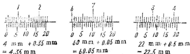
图1-12 1/20毫米游标尺的读尺寸方法
