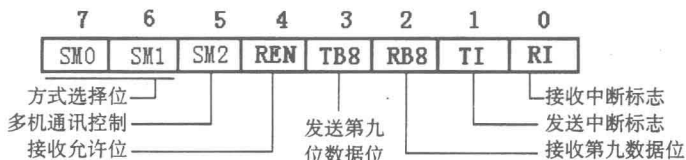
图 1-10 SCON 串口控制寄存器
