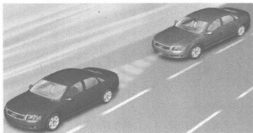
图 1-17 自适应巡航系统监测前、后车辆之间的车距
