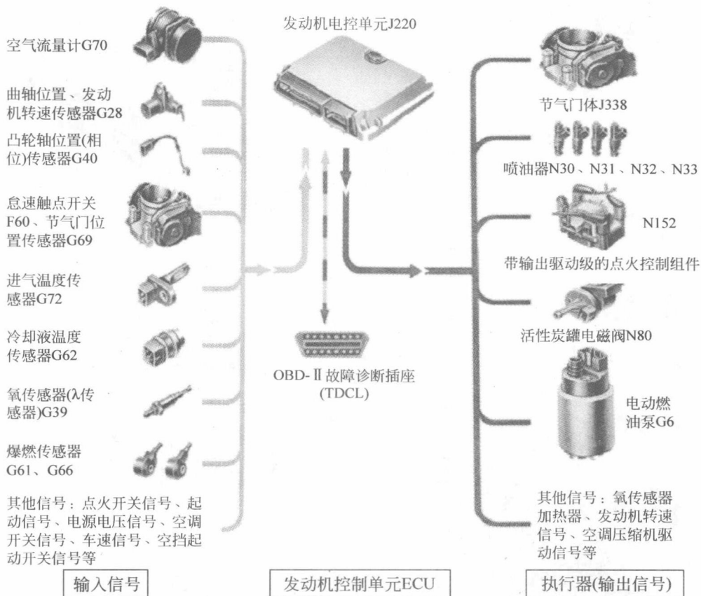
图 1-5 桑塔纳 2000 型乘用车综合电控系统的构成
