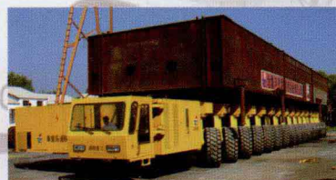
TLC900型运梁车重载(1000t) 试验实景
