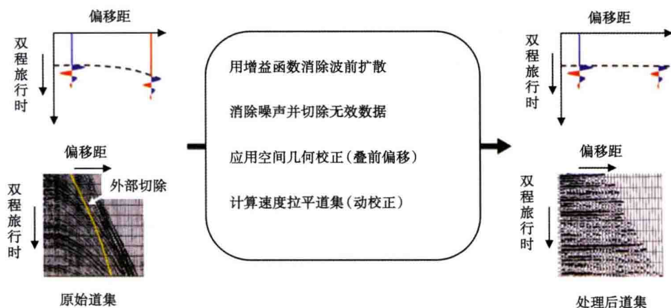
图 2.3 地震道集处理关键步骤
