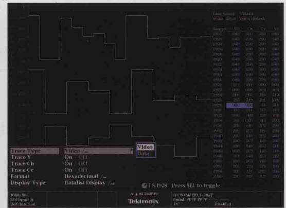
彩图 9 一行高清数字视频的 EAV 附近的数据显示
