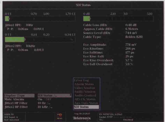
彩图 7 WFM7120 的 SDI 状态显示给出的物理层特性参数
