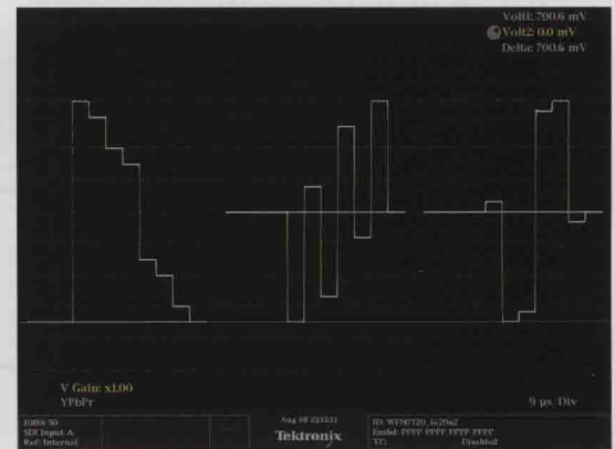
彩图 11 亮度和色差信号的模拟波形
