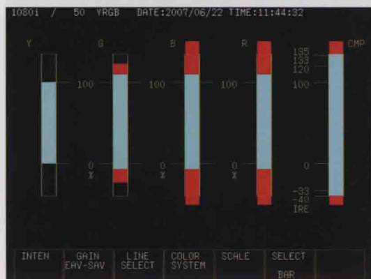
彩图 3 LV5000 波形监视器的“五条”显示
