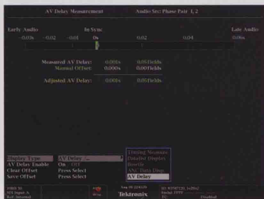
彩图 4 WFM7120“AVD”选项对音视频相对延时的测量结果
