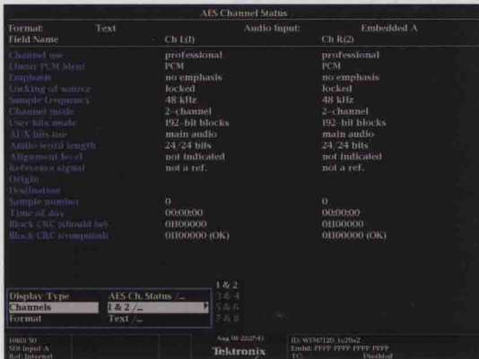
彩图 16 WFM7120 显示的嵌入音频状态分析
