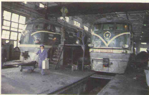
襄樊北机务段的机车正在架修。
