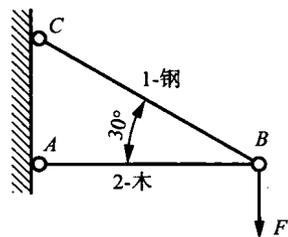
※ [2-3-5] 在图示支架中,  $AC$  和  $AB$  两杆的材料相同, 且抗拉和抗压许用应力相等, 同为  $[\sigma]$ , 为使杆系使用的材料最省, 试求夹角  $\theta$  的值。
