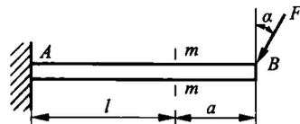
[1-2-2] 试用截面法求图示结构  $m-m$  和  $n-n$  两截面上的内力 (可暂用理论力学的符号规则)。
