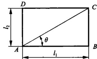
※ [1-3-3] 图示四边形平板变形后成为平行四边形 (虚线), 四边形  $AD$  边保持不变。试求: (1) 沿  $AB$  边的平均线应变; (2) 平板  $A$  点的切应变。
