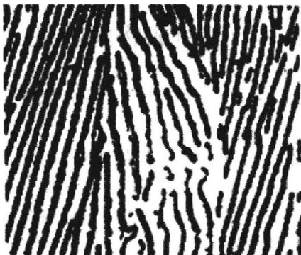
图 1-6 共析钢的显微组织 (高倍)
