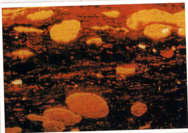
↑ 顯微鏡下的煤炭組織。圖中金黃色球狀物為該年代植物孢子，亮點為硫化鐵，黑色斑點為黏土礦物。
