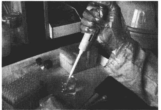
f. 放液, 按压至第一档后, 再按压第二档, 排尽液体
