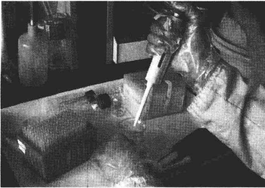
e. 吸液, 枪头尖端插入液面下, 轻拍拇指吸取液体
