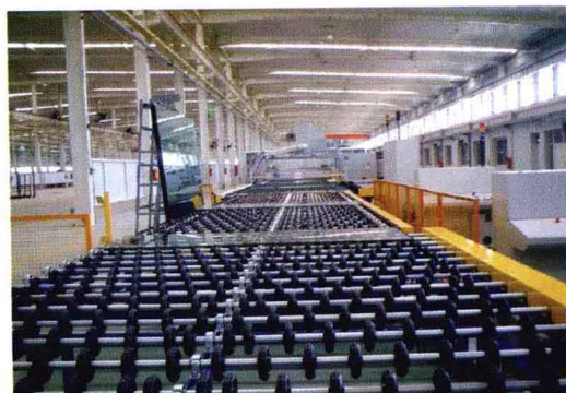
低辐射玻璃生产线
