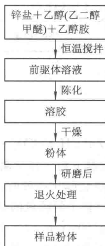
图 1.2 样品粉体的制备工艺流程图
