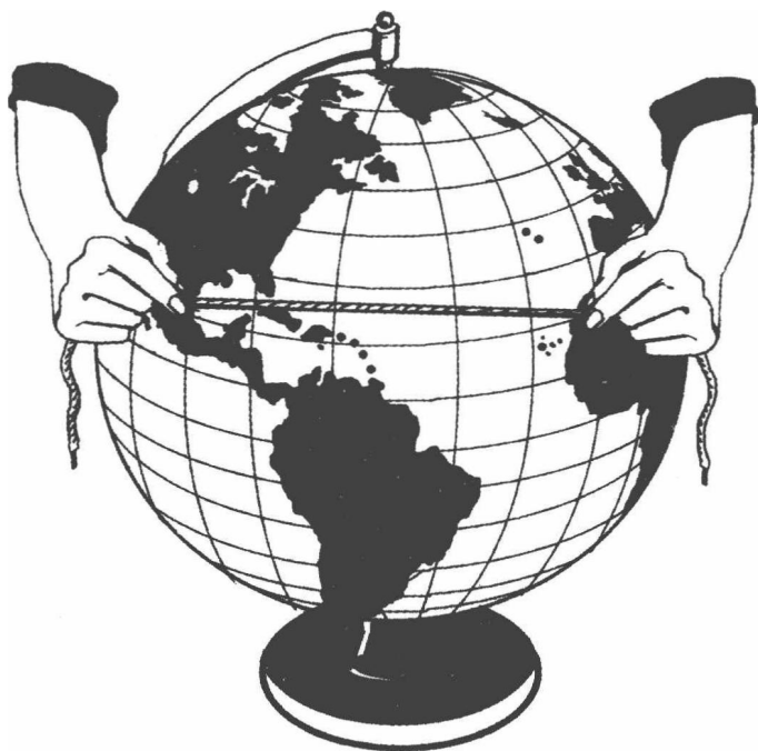
图3 用一种简单的方法就可以找出两点之间的最短距离： 在地球仪上的这两点之间拉紧一条线。
