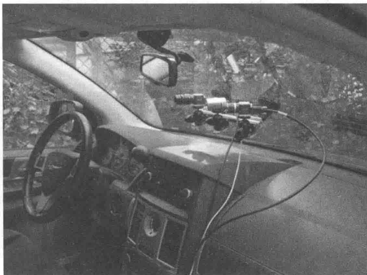
图 1.1 安装在汽车中的摄像机系统。这些摄像机可以观察驾驶员以便监控他的状态。这些摄像机也可以观察车辆的前方以便进行行人检测或路标识别。这种视觉模块将可能很快作为汽车车载驾驶员辅助系统的一部分并成为标准装置
