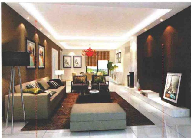
石膏板吊顶暗藏灯带
