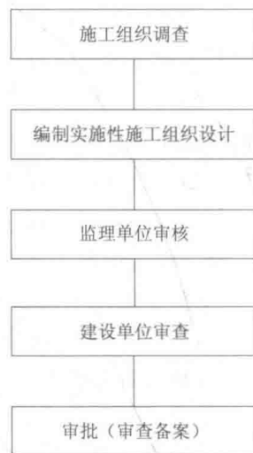
图 1-5-1 施工组织设计编制和审批流程图
