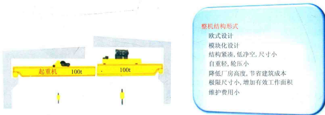
图 1-9 中欧式起重机和传统行车的技术优势比较
