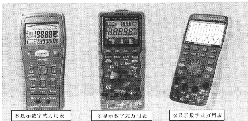
图 1-4 双显示及多显示式数字式万用表
