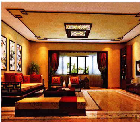
▲实木线制作角花是中式客厅吊顶中的典型元素
