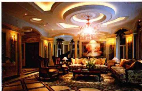
顶面 [ 石膏板造型暗藏灯带 + 石膏浮雕 ]
