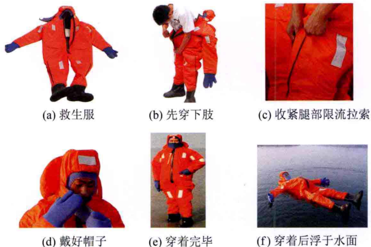
图 1-1-4 救生服穿着过程及穿着后漂浮水面
