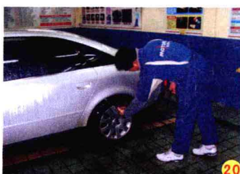
冲洗左后侧轮槽 反复冲洗直至将泥沙全部冲掉。
