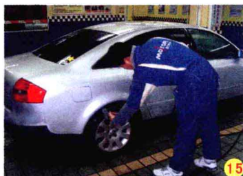
冲洗右后侧轮槽 反复冲洗直至泥沙全部冲掉。
