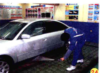
冲洗左侧车身底裙 车身底裙及挡泥板的泥沙较多，所以一定要反复冲洗。
