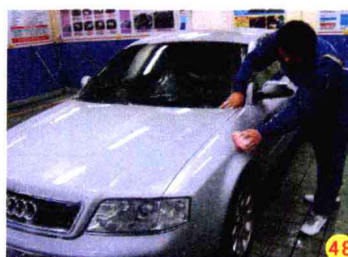
左前侧翼子板打泡沫 注意避免遗漏。
