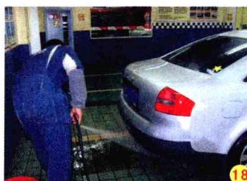
冲洗后侧保险杠 注意对保险杠底部的泥沙进行反复冲洗。
