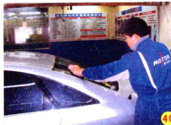
左侧后风窗玻璃打泡沫 注意避免遗漏。
