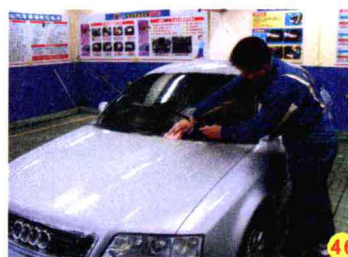
左侧刮水器打泡沫 注意刮水器底部玻璃及刮 水器打泡沫，并注意安全， 及时将刮水器归位。
