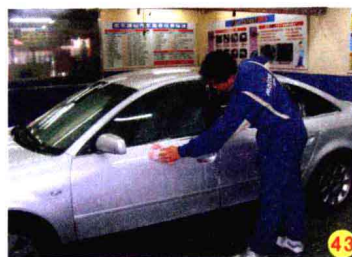
左侧车门打泡沫 注意前后两个车门手扣处 均打泡沫。
