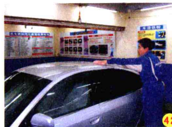
左侧顶篷打泡沫 注意避免遗漏。
