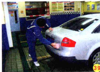
行李箱尾部打泡沫 注意车标、字母、牌照架 缝隙等处均应打泡沫。
