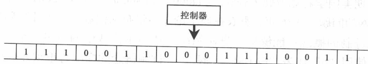
图 1-3 图灵机工作原理示意图
