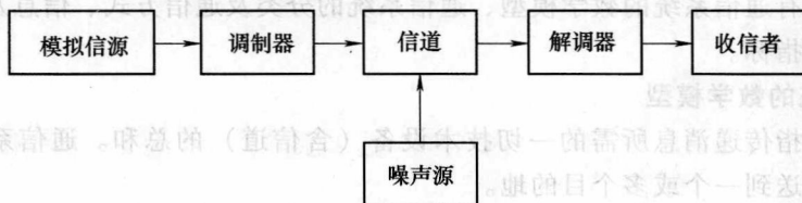
图 1-2 模拟通信系统模型
