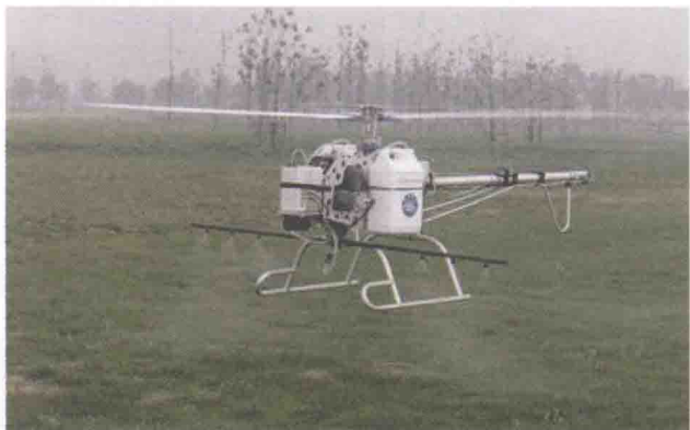
图 1-6 美国 AUH 型农用无人喷药直升机
