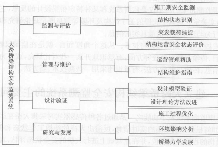
图 1-5 大跨桥梁安全监测系统的目标
