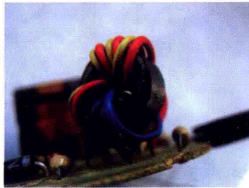
带磁环的电感器
