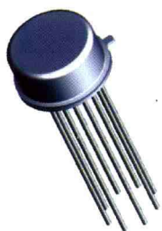
圆形金属外壳封装IC
