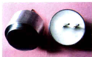
超声波传感器发射接收头
