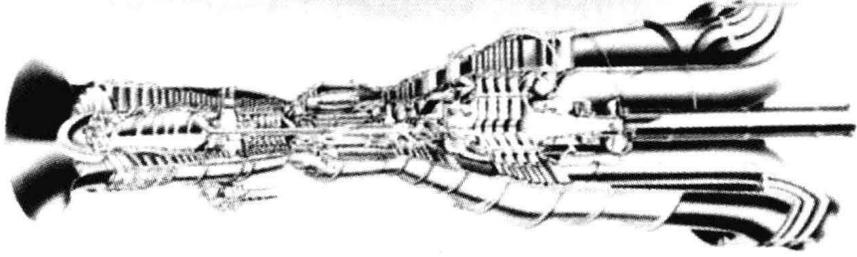
FT8 型燃气轮机结构剖视图
