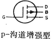
图2. MOS晶体管的图形标记 (G: 栅, D: 漏, B: 工作基体或衬底, S: 源)
