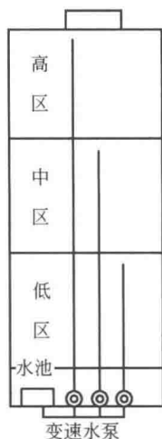
图 1-4 无水箱并联给水方式
