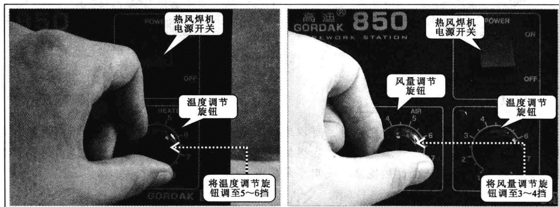
c) 调节风量和温度调节旋钮，将温度调节旋钮调至5~6挡，风量调节旋钮调至3~4挡
