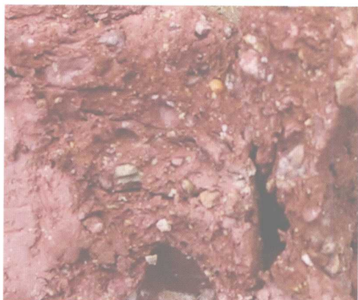
钻孔揭露的玉皇阁滑坡滑带（152米）
