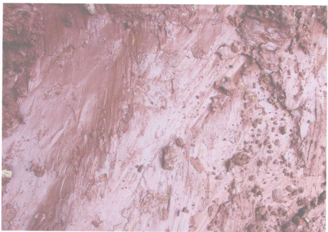
烟厂后滑体滑带中的磨光面
