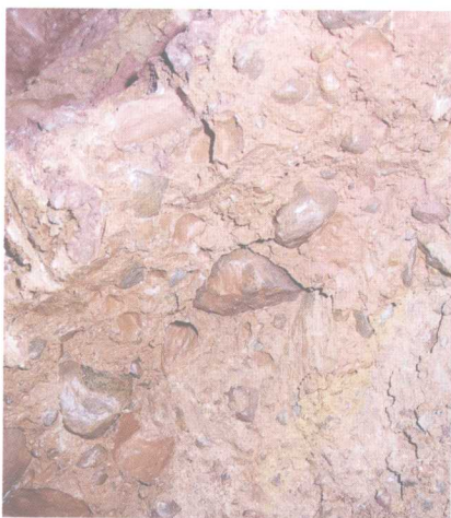
玉皇阁勘探平洞揭露的滑带磨圆砾
