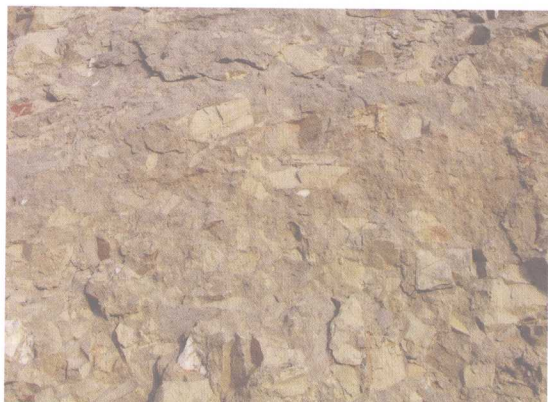
四道沟西巴东组第一段滑脱构造带内角砾岩
