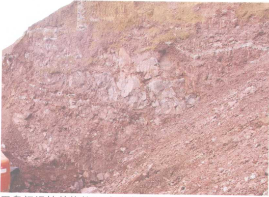
玉皇阁滑坡前缘的滑动破碎岩体
