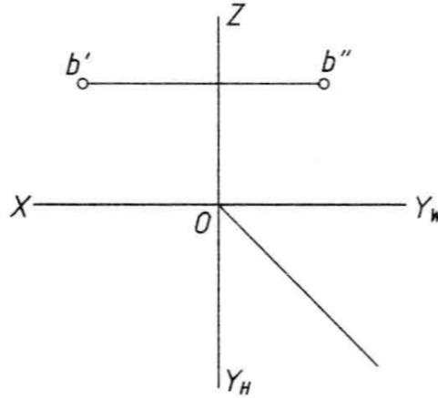
2-4 点 B 在点 A 的左面 14 mm、后面 12 mm、上面 10 mm,
