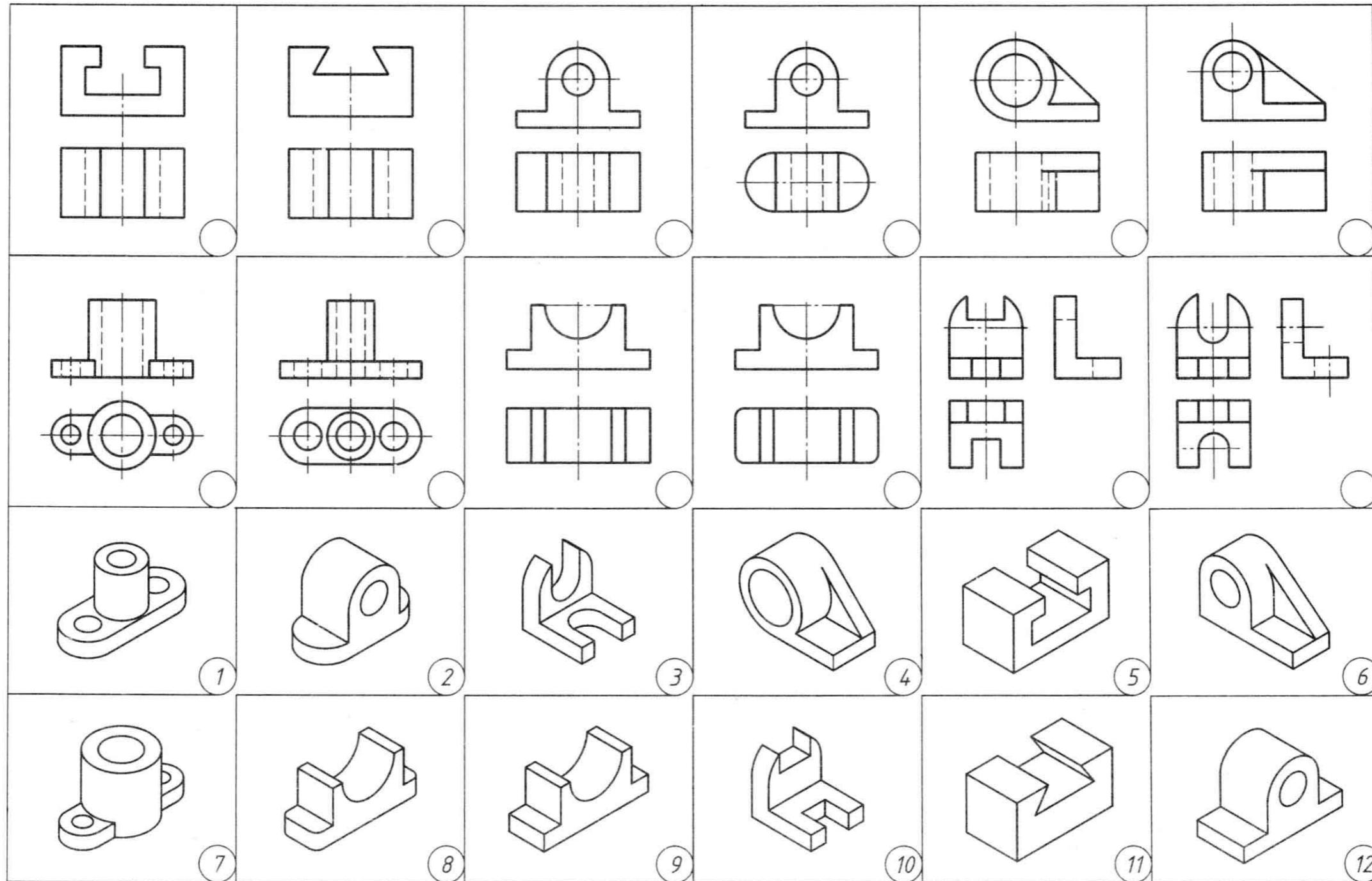
1-2 参照立体图，补画视图中缺漏的图线。
