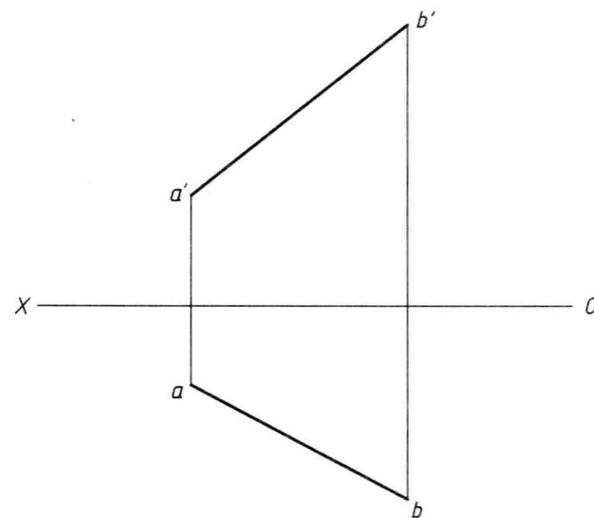
2-17 已知线段AB长28 mm, 求ab, 并求此线段与H、V面的倾角。
