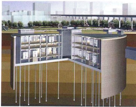
上海世博500kV输变电站地下结构图
