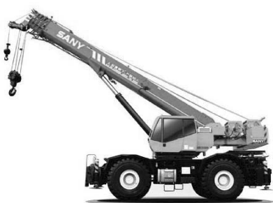
图 1-7 液压传动在起重机上的应用
