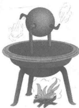
图 1.2 运用火箭推进器原理制造的蒸汽发动机
