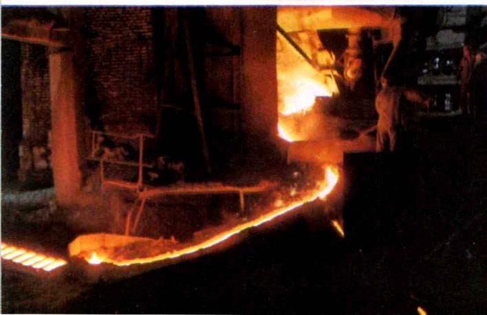
南京第三钢铁厂小高炉正在出铁
