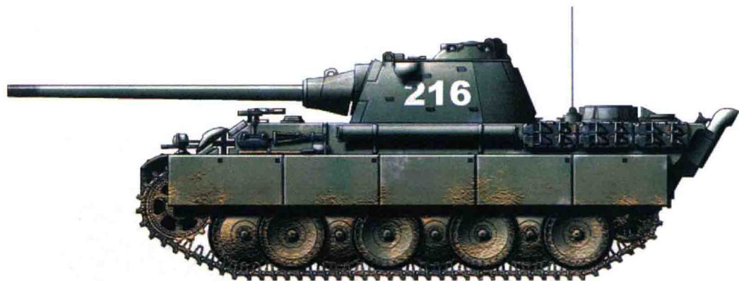
▲ Panzerkampfwagen V“黑豹”中型坦克相比于同一级别的盟军坦克拥有明显的技术优势，然而代价却是结构复杂、生产成本高昂
