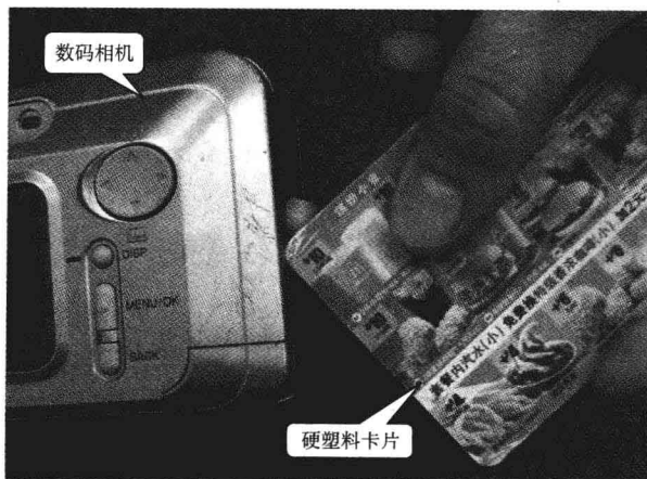
图1-3 用塑料硬片将数码相机/数码摄录机外壳分开
