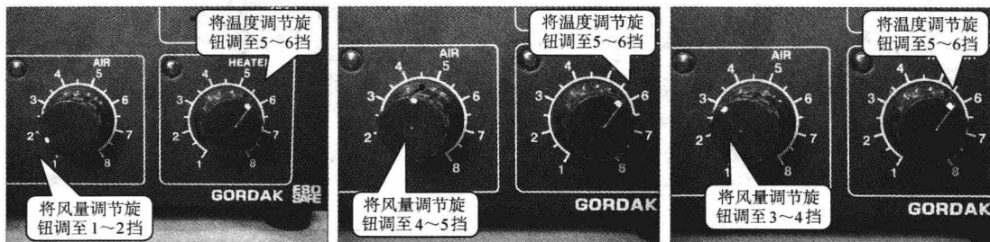
a) 拆卸/焊接小型贴片元器件时挡位设置
