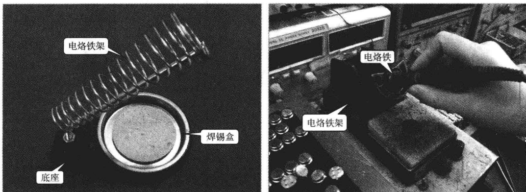
图 1-11 典型电烙铁架实物及应用
