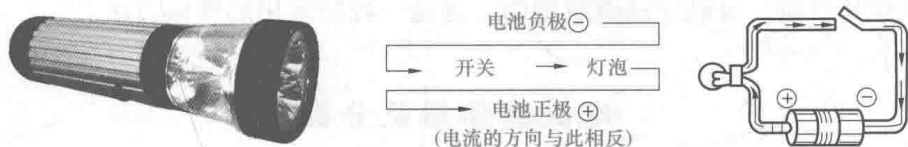
图 1-7 手电筒的工作过程
