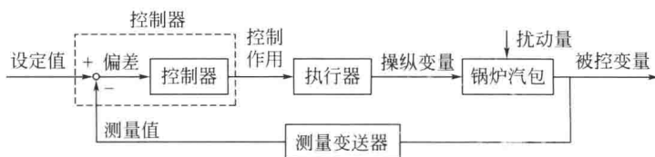
图 1-2 锅炉汽包水位自动控制系统框图
