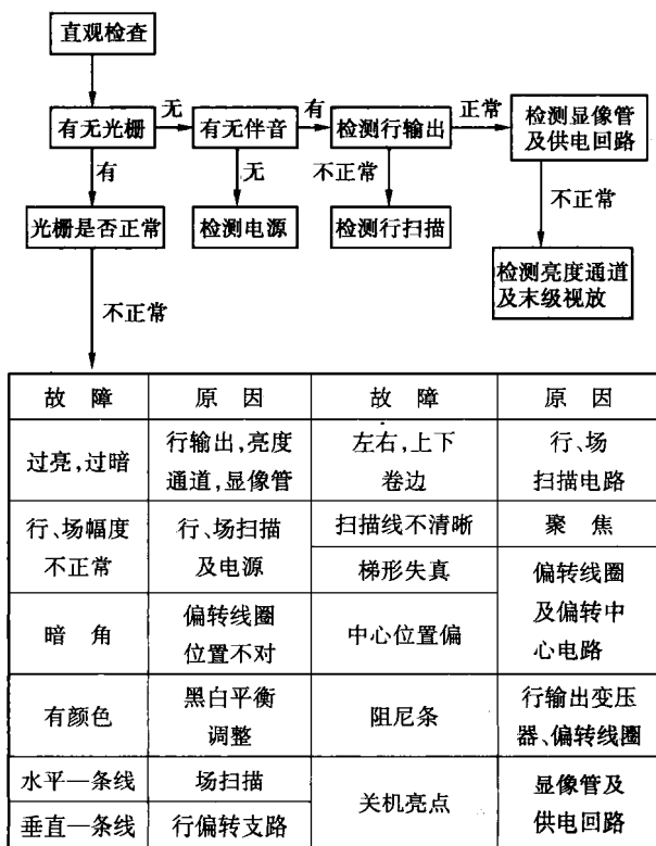
图 1.3 光栅故障的检测程序
