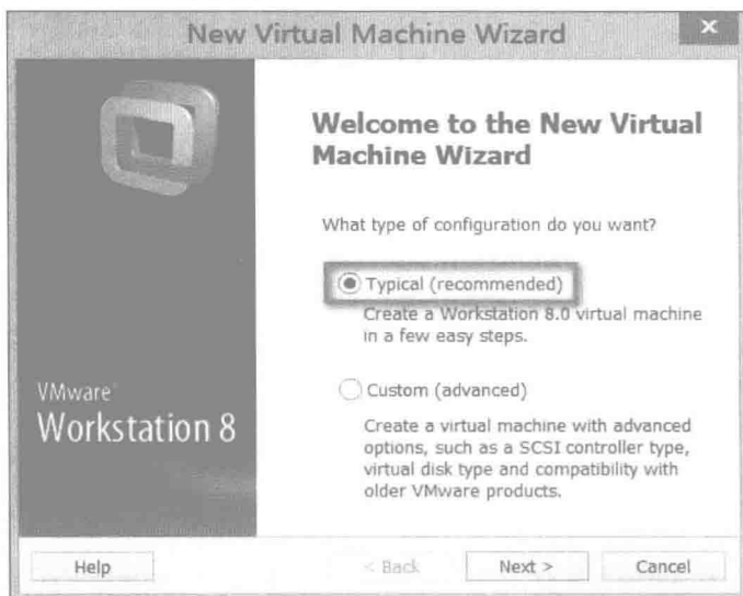
图 1-9 选择虚拟机安装类型
