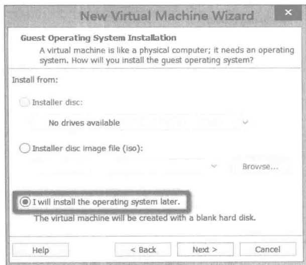
图 1-10 选择稍后安装 Linux 操作系统
