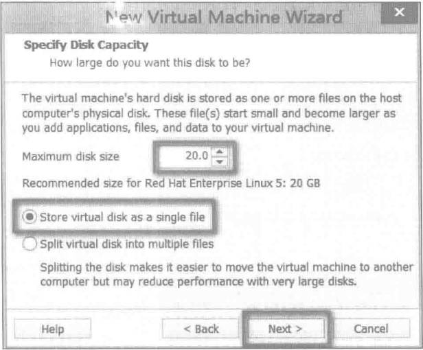
图 1-13 设置虚拟机硬盘容量
