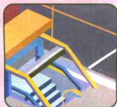
地下过街通道
